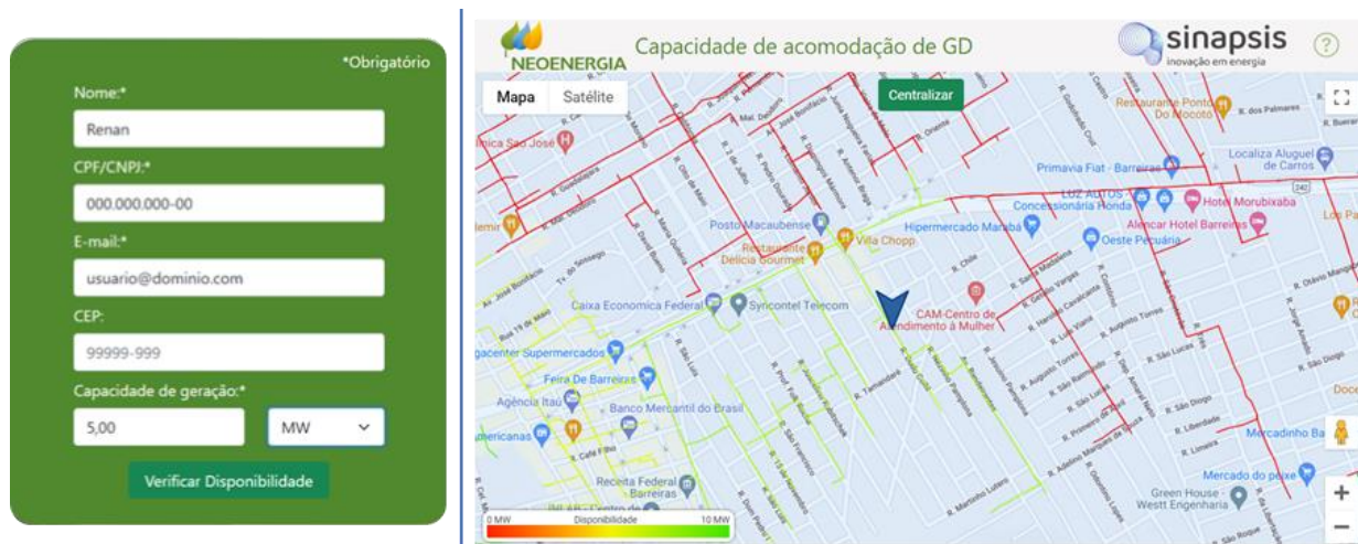
Figura 3 - Sistema de consulta Hosting Capacity - (a)esquerda: tela inicial de direcionamento de consulta; (b)direita: consulta de alimentadores de média tensão
